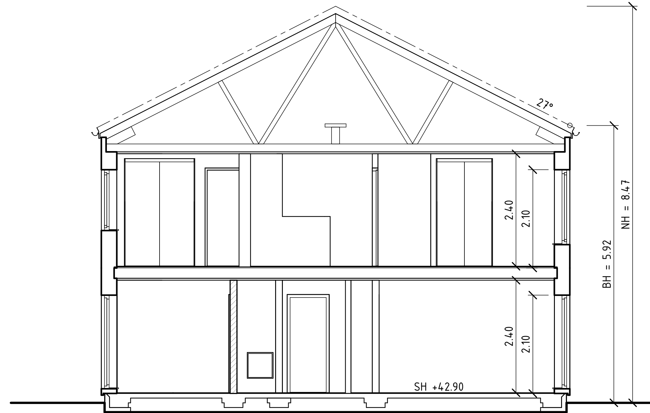
SEKTION A-A 1 : 50 Tvärsnitt, mått
